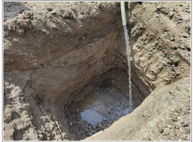
Prova di permeabilità a carico variabile
