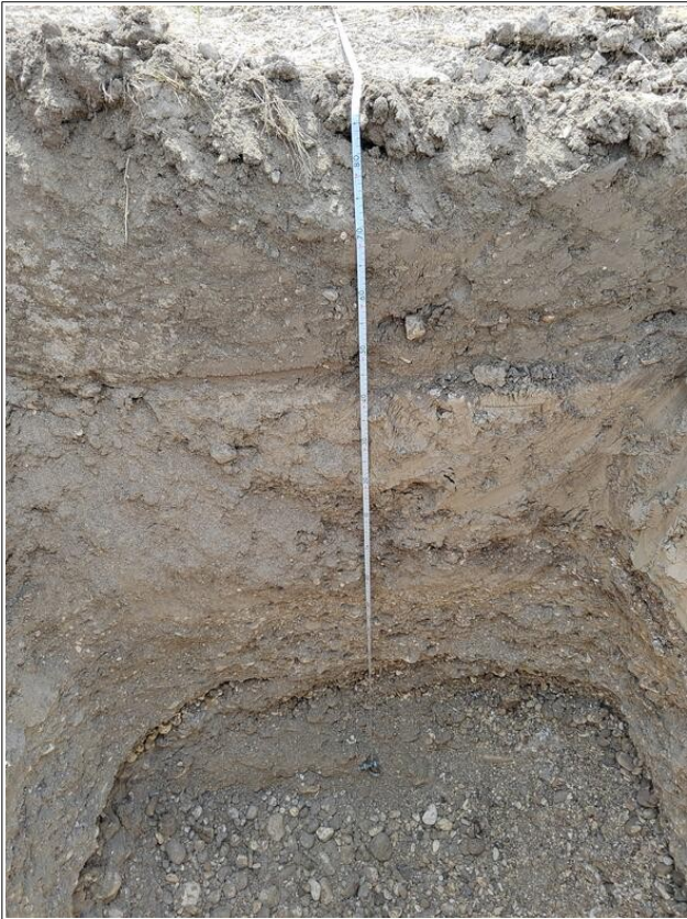
Scavo per l'esecuzione della prova di permeabilità
